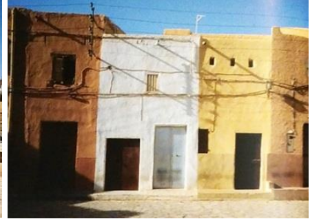
صورة (٢٠ و ٢١) صورتان فى الجزائر بلدة Ghardia- Valley of M'Zab- لمسكن غنية بالألوان الساخنة من صبغات عضوية و طلاء غليظ خشن عازل لسطح الحوائط.
